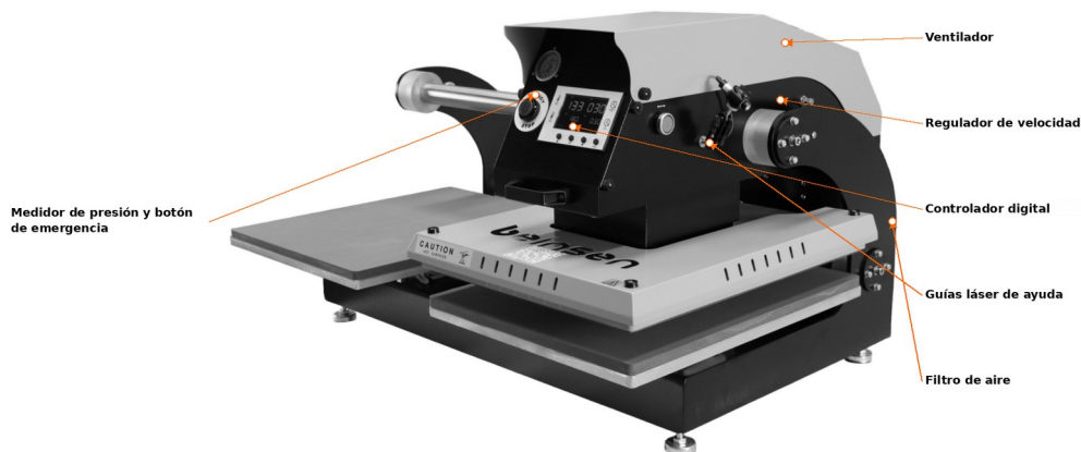
Fig. 1 · Componentes principales del equipo Beinsen Normandía I.
